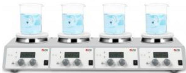
Мешалка магнитная, объем по воде 10 л на 1 место, 4 места, диаметр платформы 135 мм, нагрев до 340 °С, 200-1500 об/мин, MS-H340-S4 Dlab 8030271110
