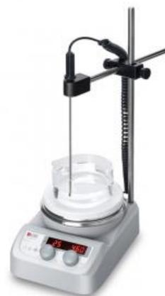
Мешалка магнитная, объём по воде 3 л, d платформы 135 мм, нагрев до 280 °С, 200-1500 об/мин, датчик РТ1000, штатив, MS-H280-Pro package 2 Dlab 8130101212+18900540
